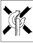
Fig. 3 c Kroksperran blokkert!
