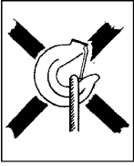
Fig. 3 a Slyngen belaster krokspissen!
