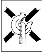
Fig 3 c Krokspärren blockerad!
