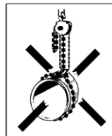
Kuva 2 e Kuormaketjua ei saa käyttää silmutkana!
