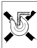
Fig 2 d Krokspetsen dessutom utsatt för böjpåkänning!
