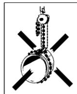
Fig 2 e Lastkättingen får ej användas som sling!
