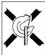
Fig 2 a Slinget belastar krokspetsen!
