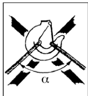
Kuva 2 b Yläkulma liian suuri silmutkassa! \alpha enint. 60°
