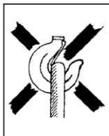
Fig 2 c Krokspärren blockerad!
