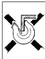
Kuva 2 d Koukun kärkeen vaikuttaa lisäksi vääntävä kosketusrasitus!
