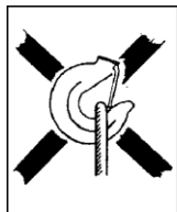
Kuva 2 a Silmukka kuormittaa koukun kärkeä!
