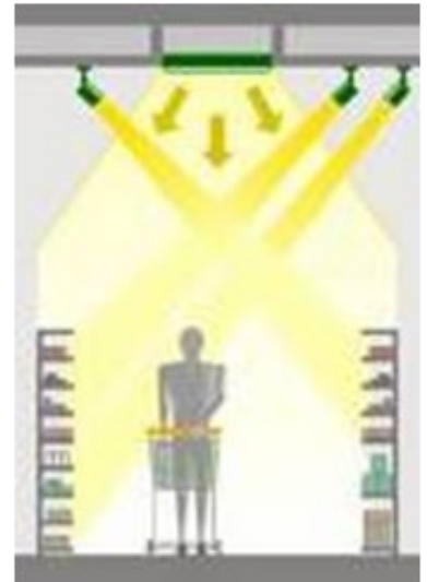
Særbelysningen lyser skråt ind på hylderne. Figur: Architecture et Climat, LOCI, Université Catholique de Louvain, Belgien.
