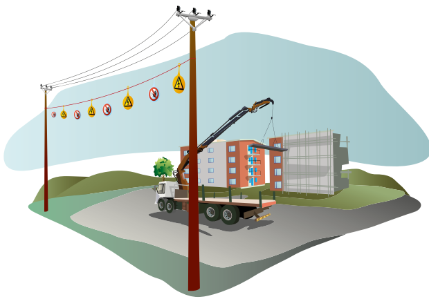
Bild 24 - Användning av stora fordon i närhet av en luftledning kräver planering.
