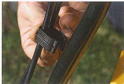
Sladdklämmorna på Wolf-Gartens maskin är slappa och lossnar för lätt.
