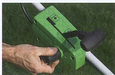
På Vikings maskin kan du ställa in knivarnas skärdjup med en ratt på handtaget.
