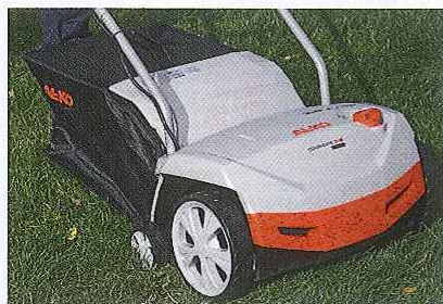
Maskinen från Al-Ko tippas lätt bakåt eftersom hjulaxlarna sitter för tätt.
