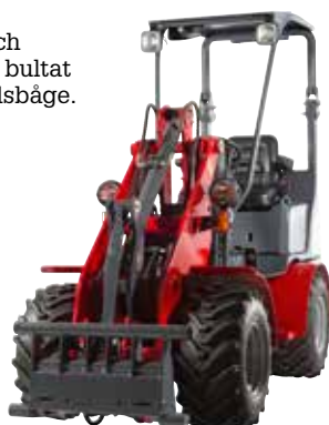
1133CAB (ovan) har ljudisolerad hytt med värmepaket, torkare fram och bak, öppningsbar bakruta och golvmattor i gummi som standard. Modellen på bild är utrustad med allrounddäck.
