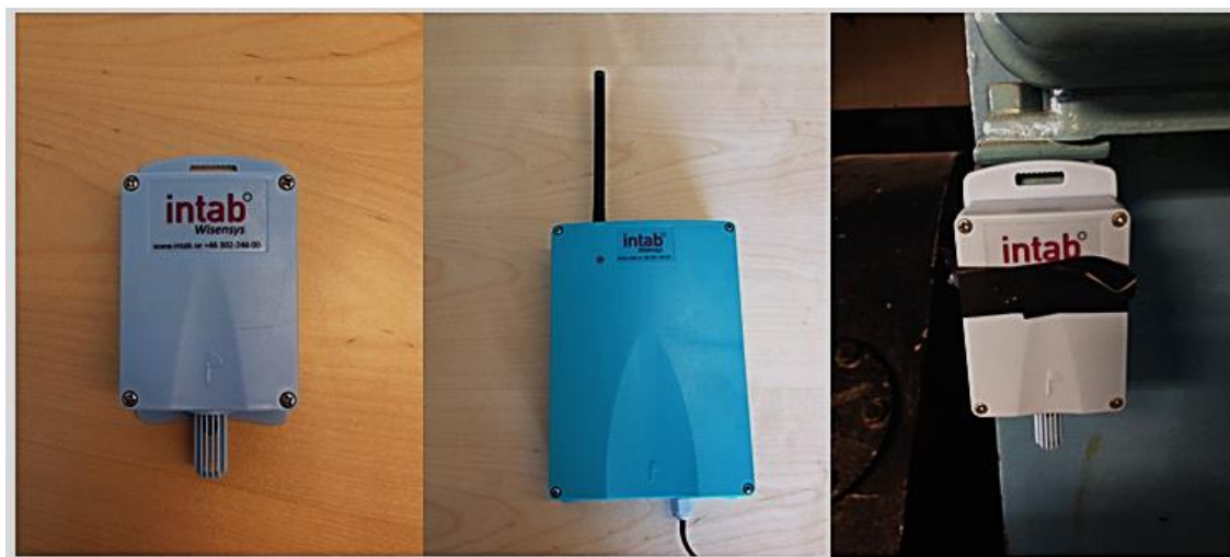
Figur 7 Från vänster: givare, basstation, montering av givare i intagshuset. (Foto: Amanda Åström)
