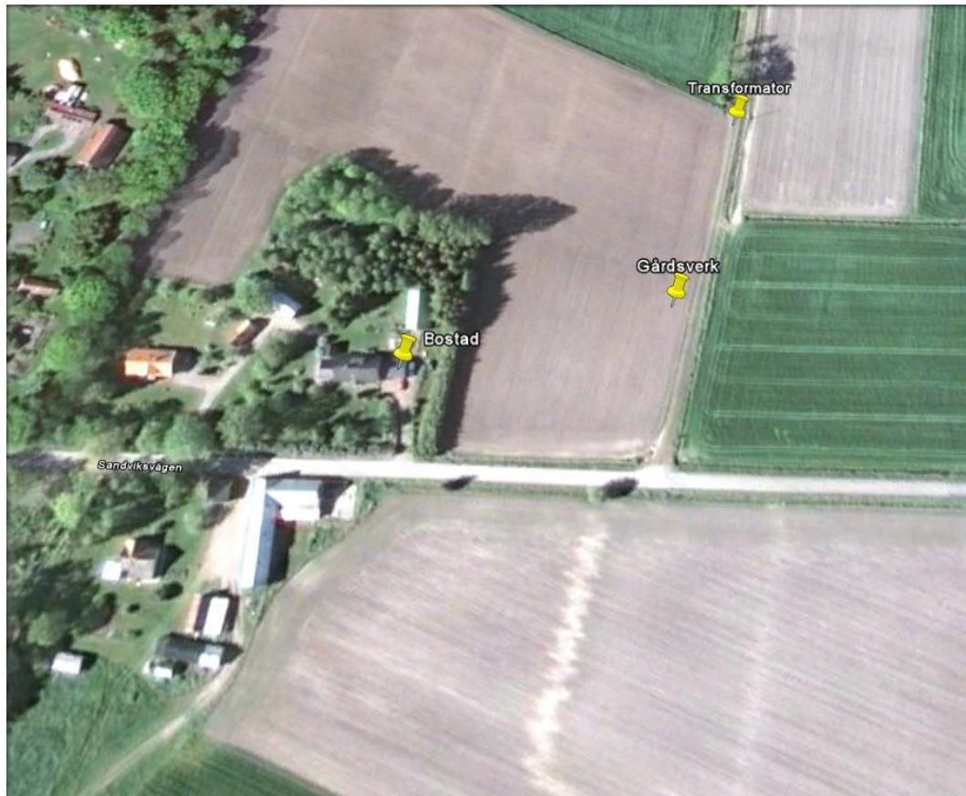
Bild 5; Den tänkta placeringen av vindkraftverket. Bostaden och transformatorn är också utmärkta på bilden.
