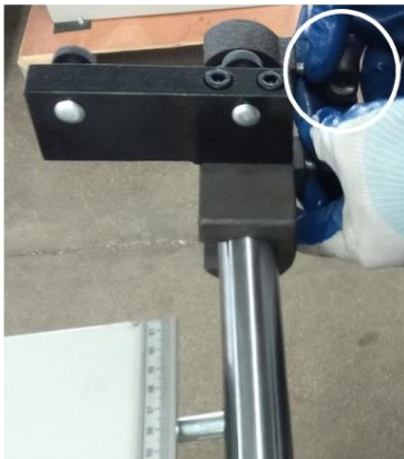
Bild 9: Skjuta upp bäraren på styrskenan
