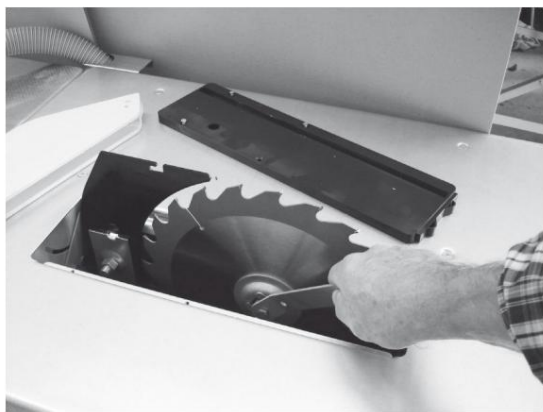
Bild 39: Lossa sågbladet med sågbladsnyckeln
