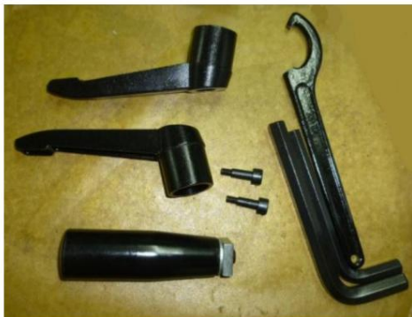
Bild 5: Ingående material och verktyg för TF 200 SE
