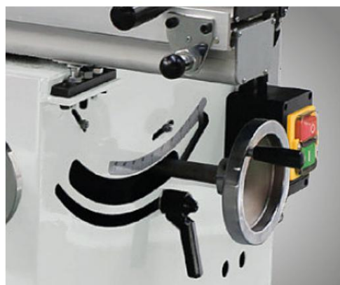
Bild 21: Handratt för justering av sågbladets höjd
