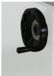
Bild 22: Handratt för justering av lutningsvinkeln (vänster)
