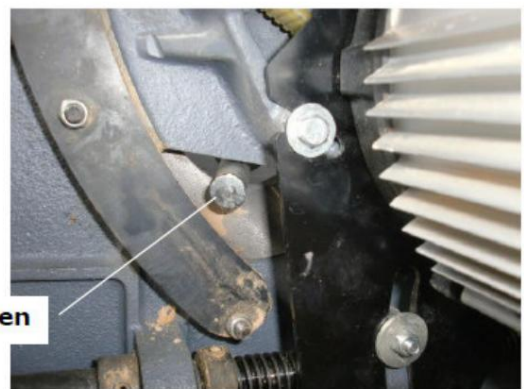
Bild 5: Justering av remspänningen
