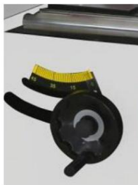
Bild 22: Handratt för justering av lutningsvinkeln (vänster)
