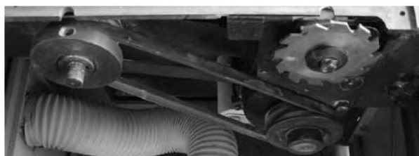
Bild 28: Byte av drivrem
