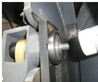
Bild 9: Montering av sågbladsspindeln
