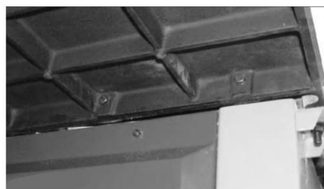
Bild 10: Montering av förlängningsbordet i gjutjärn
