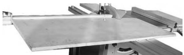
Bild 35: Stopp i främre position för stora arbetsstycken
