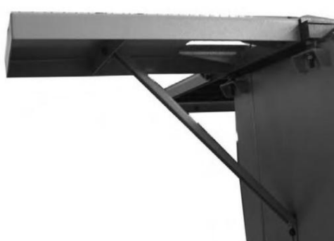
Bild 13: Fastskruvning av det bakre förlängningsbordet
