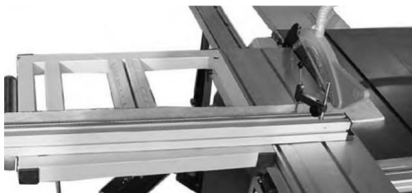
Bild 36: Stopp i bakre position för mindre arbetsstycken
