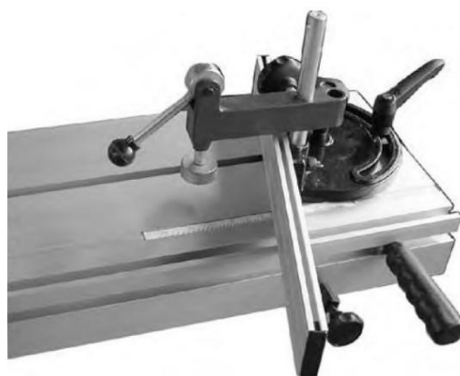
Bild 40: Skalor för geringssnitt på vinkelanslaget
