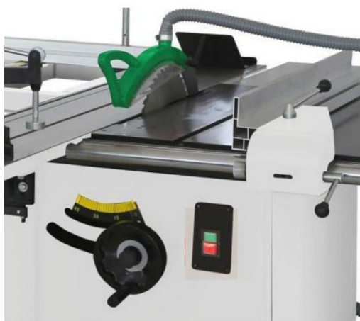
Bild 43: Handratt för justering av sågbladets höjd
