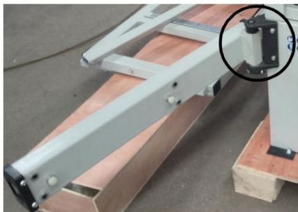
Bild 18: Montering av svängarmen
