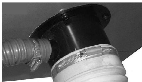
Bild 27: Montering av sugslangarna
