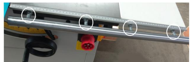
Bild 14: Montering av stoppstyrskenan
