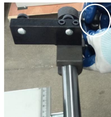
Bild 15: Skjuta upp bäraren på styrskenan
