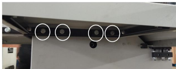
Bild 11: Montering av förlängningsbordet
