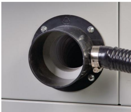
Bild 23: Montering av utsugsporten
