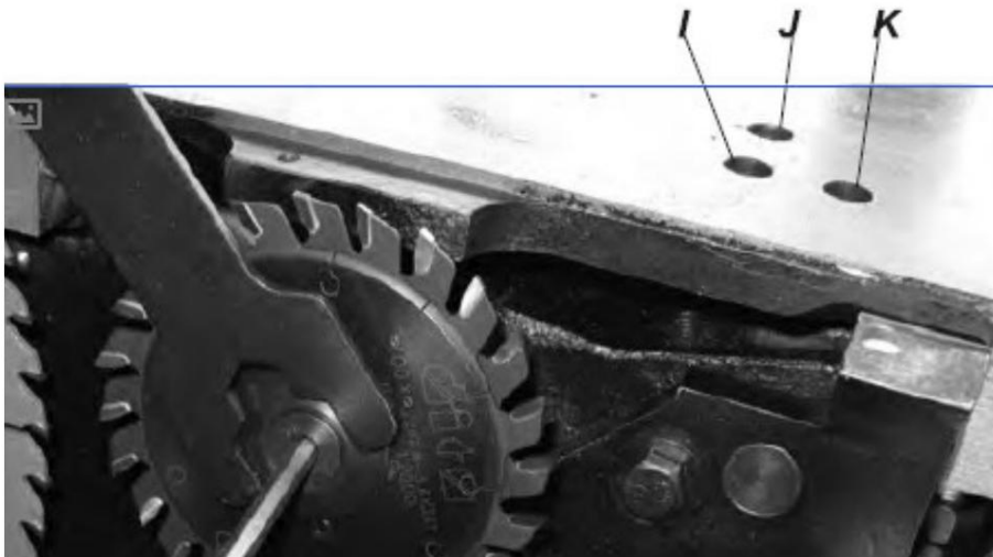
Bild 5-15: Justering av ritssågbladet
