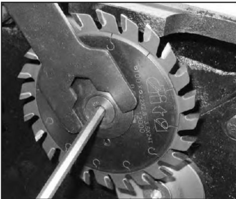
Bild 5-12: Modifiering och anpassning av Vlorritzer-sågbladet
