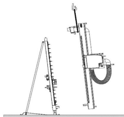
Bild 12: Montering av sågaggregatet
