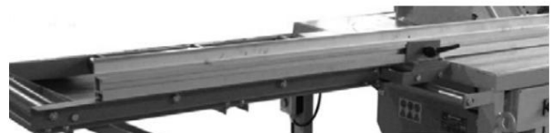
Bild 25: Montera rullbordet med stödben
