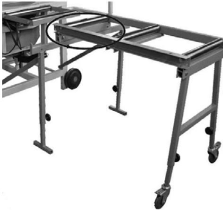
Bild 21: Montera rullbordet med stödben
