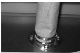
Bild 20: Byte av bypass-filter
