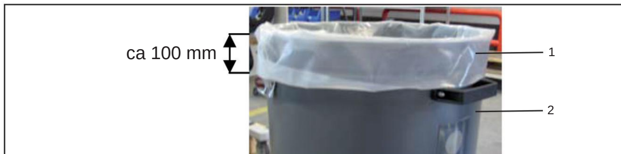
Fig. 8 Påfyllning av behållare med spånpåse
