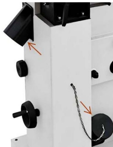
Bild 16: Montering av sugslangen
