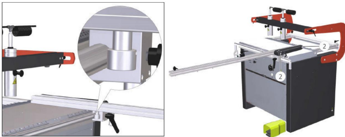
Bild 7-3: Justering av förlängningsstoppet i tvärriktningen
