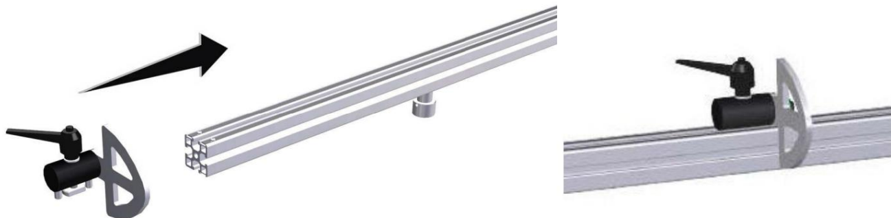
Bild 5-7: Montering av det rörliga stoppet
