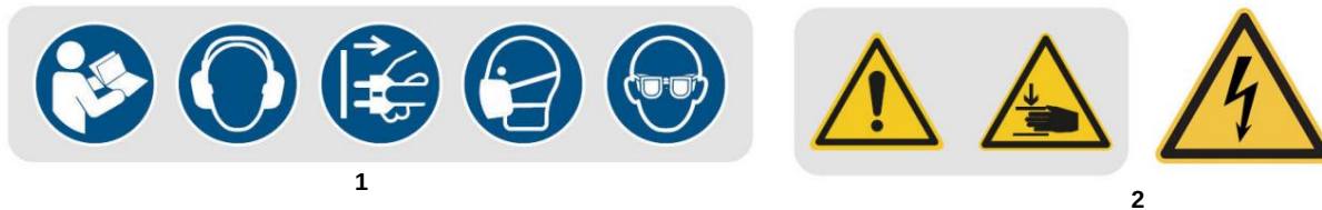
Bild 1-2: Säkerhetsskyltar - 1 Obligatorisk skylt: Följ instruktionerna, använd hörselskydd, dra ur sladden, använd mask, använd ögonskydd | 2 Varningssignaler: allmän varningssignal, varning för handskador, varning för elektrisk spänning
