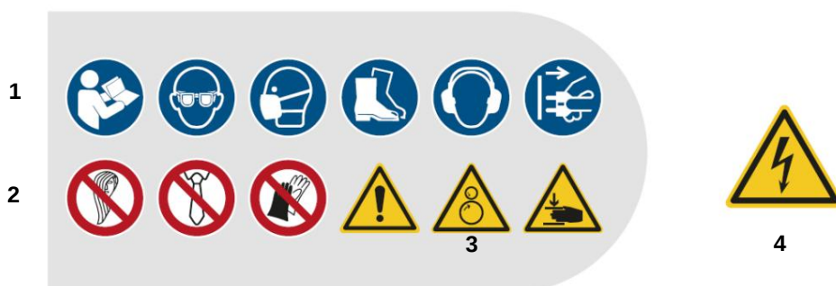
Bild 1-1: Säkerhetsskyltar - 1 Obligatorisk skylt: Följ bruksanvisningen, använd ögonskydd, använd ansiktsmask, använd fotskydd, använd hörselskydd, dra ur sladden, 2 Förbudsskylt: Användning med långt hår förbjuden!, Användning med slips förbjuden!, Användning av handskar förbjuden! | 3 Varningsskylt: Allmän varningsskylt!, Varning för roterande rullar!, Varning för handskador! | 4 Varningsskylt: Varning för elektrisk spänning!
