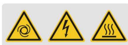
Bild 1-1: Säkerhetsmarkeringar: 1 obligatorisk skylt - följ instruktionerna, använd hörselskydd, dra ur nätsladden 2 varningsskyltar - varning för automatisk start, varning för elektrisk spänning, varning för het yta
