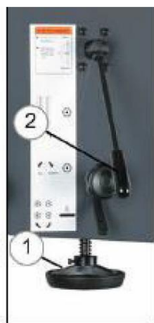
Bild 12: Justering av remspänningen
