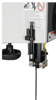
Bild 7: Applicering och montering av lasern
