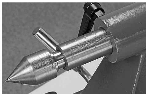
Fourreau de la contre-poupée avec graduation
