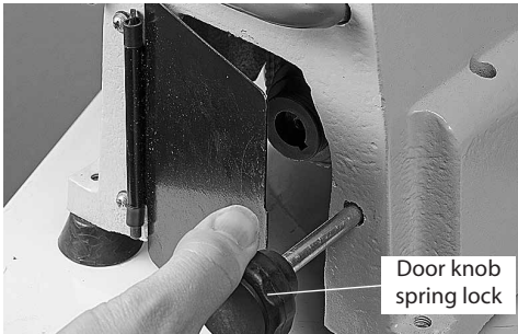
Motor pulley access door
