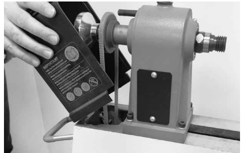
Nehmen Sie die Spindelstockabdeckung ab, um die Riemenscheiben freizulegen.
