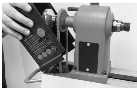
Abaissez le couvercle de la poupée pour dévoiler le système de poulies
