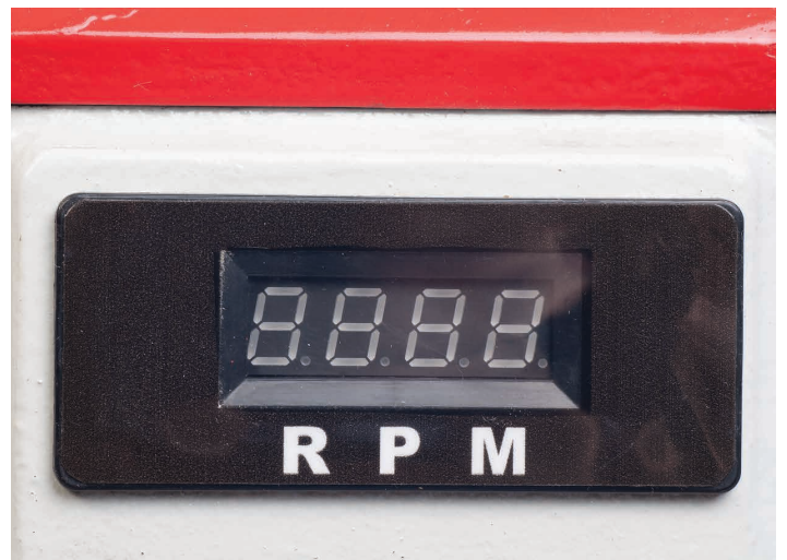
Digitalanzeige der Spindeldrehzahl
