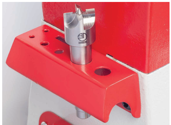
Werkzeughalter/Tragegriff zu beiden Enden der Drehbank
