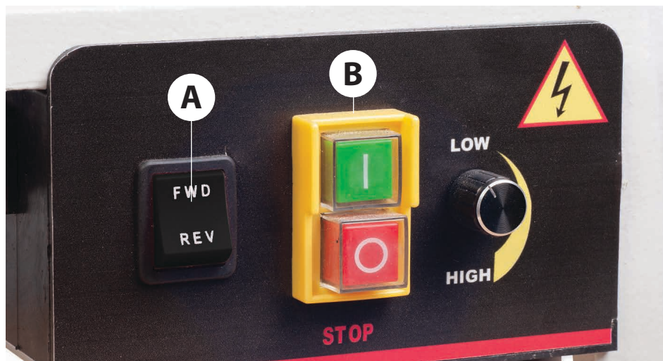
Interrupteur de marche avant/arrière pour modifier le sens de la broche (A) (ne touchez PAS à cet interrupteur tant que le tour fonctionne) Interrupteur de marche/arrêt à enclenchement sous manque de tension (B)
