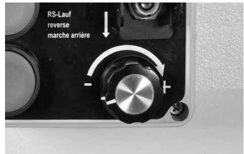
Le bouton de commande de la vitesse vous permet d'accroître ou de diminuer la vitesse de la broche
